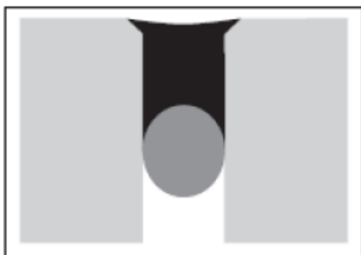
Wypełnienie szczeliny na płasko zmniejsza ryzyko potykania się i zapobiega zbieraniu się brudu
